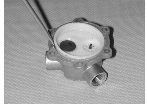
Den im Pumpenoberteil befindlichen O-Ring und das Sieb entnehmen.
