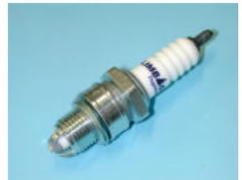
An den oben genannten Zündkerzen wird der Elektrodenabstand nicht mehr eingestellt. Die werksseitige Einstellung darf nicht verändert werden. Der Verschleiß der Zündkerze wird nicht als Abbrand an den metallischen Elektroden ermittelt sondern an der Hilfselektrode. Mit zunehmender Gebrauchsdauer findet an der Hilfselektrode ein Materialabtrag statt (siehe unteres Bild), der im Extremfall bis zum partiellen Abtrag der Hilfselektrode führen kann.
