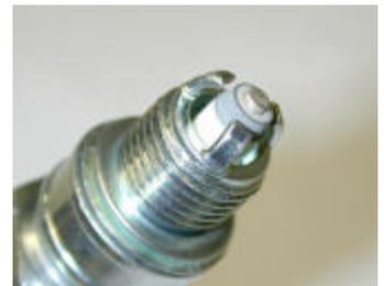
Diese Zündkerzentypen können, bedingt durch das Fehlen der Abschirmung, nur mit speziellen Zündgeschirren verwendet werden, wie sie in der Technischen Mitteilung Nr. 63 spezifiziert worden sind.
